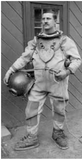
Datidens dykkerdragter var tunge og klodsede og gav ikke megen mulighed for at navigere under nedstigningen. Først på bunden kunne dykkeren bevæge sig (nogenlunde) frit. Det var i dragter som disse, Svitzers dykkere og Juel-Brockdorff arbejdede omkring Dykkeren . Orlogsmuseets arkiv
